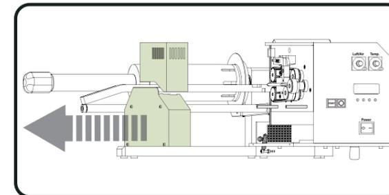
5. Schraube am Transport-Rad gegen den Uhrzeigersinn vorsichtig lösen:
