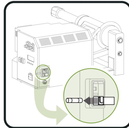
5. Die daneben liegende Ersatzsicherung entnehmen und in den Sicherungshalter einsetzen.
