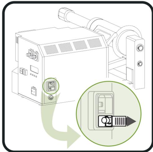
4. Sicherung aus dem Sicherungshalter nehmen:
