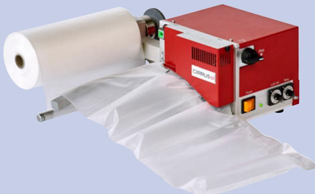
Kleine, aber leistungsfähige Luftpolstermaschine, die leicht transportiert und verstaut werden kann.
